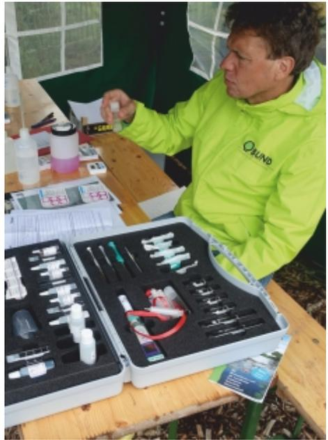
*Der Autor beäugt kritisch das Ergebnis einer Nitrat-Messung von einer Wasserprobe aus einem Hausbrunnen bei Hechthausen. (© Gerd Bertholdt)*
